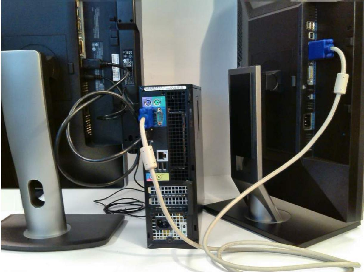
**VGA-Stecker** (Analog; Anschluß für ältere Monitore)
