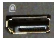
Verwechslungsgefahr mit HDMI-Stecker! Beim Displayport ist eine Ecke abgeschrägt, beim HDMI zwei (siehe auch HDMI)!
