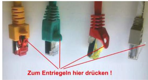
**Dieser Stecker hat eine mechanische Verriegelung! Um diese zu lösen auf den Kunststoffhebel drücken, diesen gedrückt halten und erst dann den Stecker herausziehen! Niemals mit Gewalt !!! Diese Stecker bzw. Buchsen zerbrechen sehr schnell!**
