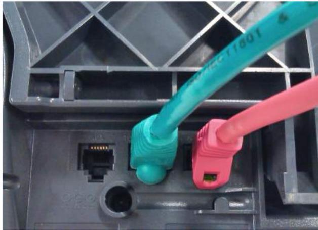
Grünes Kabel (links) z.B. zur LAN 1 Buchse am Mini-Switch; rotes Kabel (rechts) zum PC
