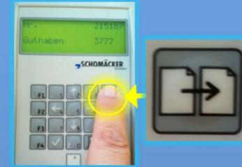
3. Nun kann das System zum Kopieren benutzt werden. Wenn eine Vorlage in den Einzug oder auf das Vorlagenglas gelegt wird, wird der **Auslösetaster Blau** und es kann damit der **Kopiervorgang gestartet** werden.
